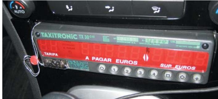
Se precinta el taxímetro entre el tornillo de desmontaje de la tapa de programación, el tornillo que sujeta la tapa trasera de conexiones del taxímetro y el tornillo de acceso a la electrónica.
