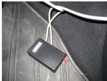
El indicador se precintará de forma que las conexiones sean inaccesibles. En este caso el indicador dispone de un precinto en su parte central que impide el acceso a las conexiones:
